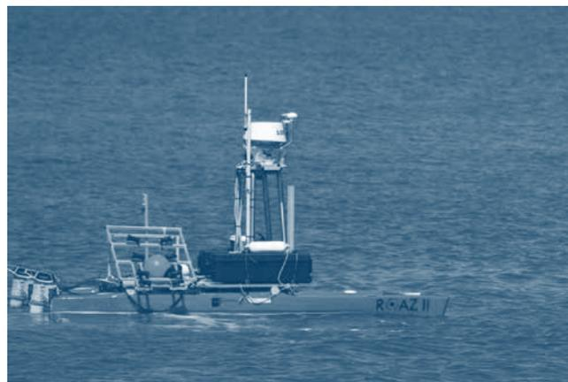
**Figura 3:** Veículo Autónomo de Superfície ROAZ
