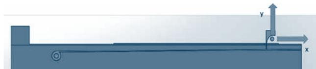
**Figura 7** Esquema dos eixos das forças, da conduta e do Flap. A Azul, temos a componente vertical e a verde temos a componente horizontal
