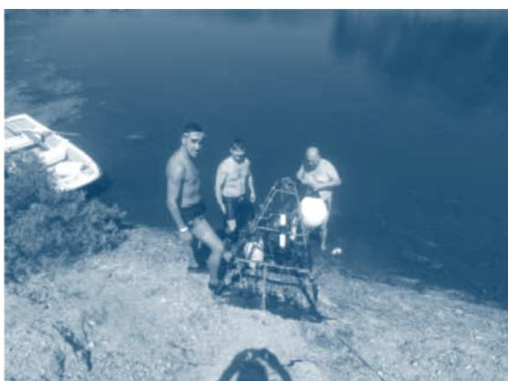
**Figura 4** Processo de ancoragem e recolha da estrutura de aço inoxidável com todo o matéria descrito, auxiliado por três flutuadores.
