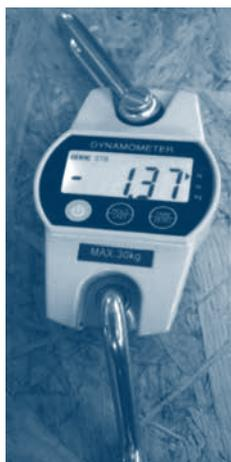
**Figura 6** Dinamómetro portátil com capacidade máxima de 30 kg
