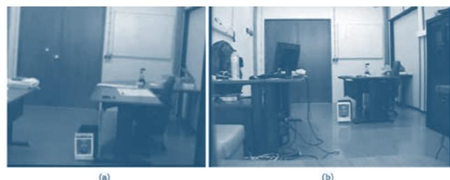
Figura 21 A deteção de um alvo na câmara 1 (a) permite posicionar a câmara *pan-tilt* (b) de modo a observar o mesmo alvo.
