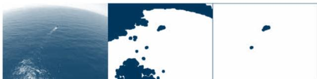
**Figura 4** Resultados do processo de análise de manchas. A imagem original (à esquerda) é binarizada através de thresholding dos canais RGB e processada com um método de componentes conexos (ao meio). Um processo de análise de manchas permite identificar mais precisamente zonas que possam conter embarcações (à direita)
