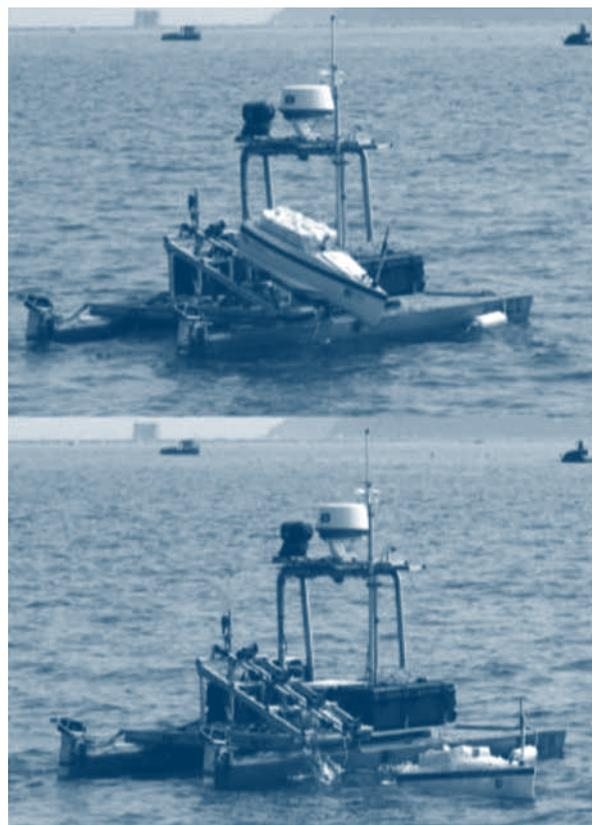
**Figura 10:** Lançamento da cápsula de salvamento robótica UCAP pelo veículo de superfície ROAZ
