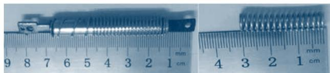
**Figura 2** Mola A, comprimento mínimo 8,3 cm; Mola B, comprimento mínimo 3cm.
