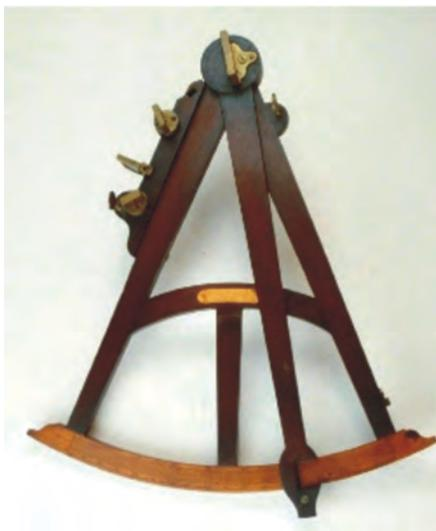
Figura 12 - Um dos primeiros instrumentos de dupla reflexão, um octante
