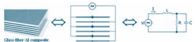
Figura 3 Esquema do conceito desenvolvido para monitorização dos danos estruturais no GLARE.
