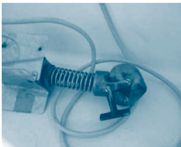
Figura 17 Aparelho de recolha de sedimentos em altas profundidades.
