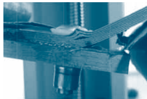
Figura 13 Delaminação das camadas de alumínio sujeita à compressão durante o ensaio de flexão em 3 pontos.
