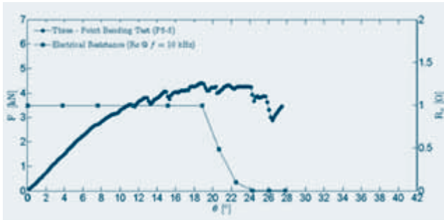
Figura 15 Representação gráfica da curva força-ângulo de flexão e resistência eléctrica-ângulo de flexão do provete P5-5.
