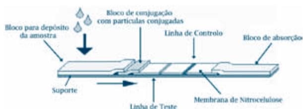
Figura 1.6 Componentes de um dispositivo de fluxo lateral (adaptado de [21]).
