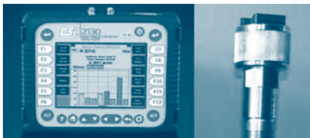
Figura 3 Equipamento de medição: CSI 2130 da Emerson e o acelerómetro usado na recolha de dados: A0760GP.
